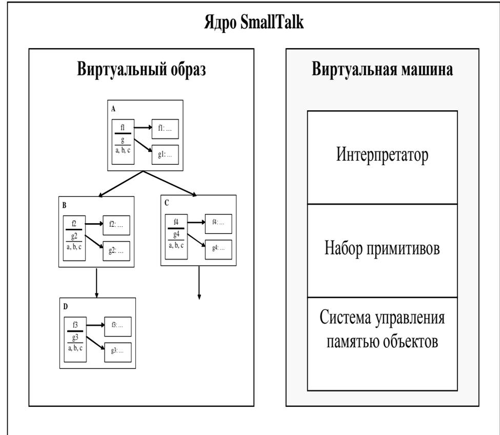
Виртуальный образ - откомпилированный образ написанной на Смолтоке части системы. Это встроенный набор классов и методов (за исключением примитивных методов).
